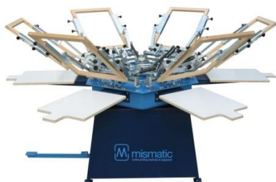
☺ es. macchina serigrafica manuale a carosello modello MMC6
