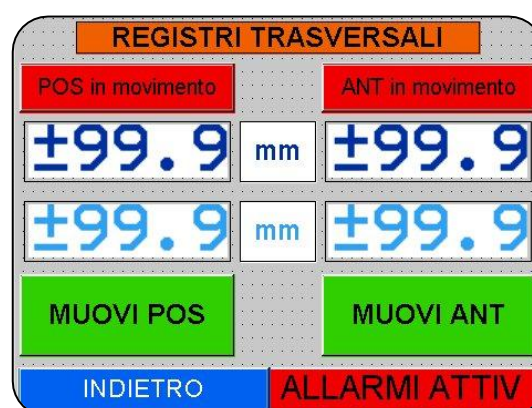
monitor LCD: sistema per la regolazione micrometrica del porta telaio
