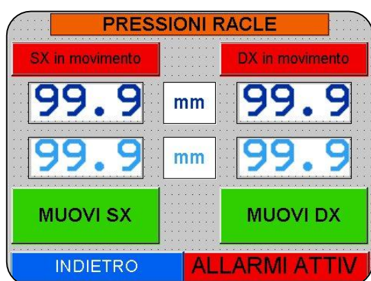
monitor LCD: sistema per la regolazione delle pressioni di stampa
